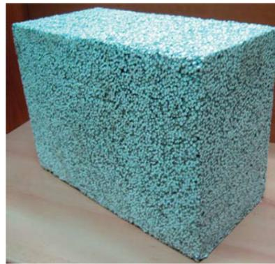
Рис. 6. Откалиброванные полистиролбетонный стеновой блок и перемычки
