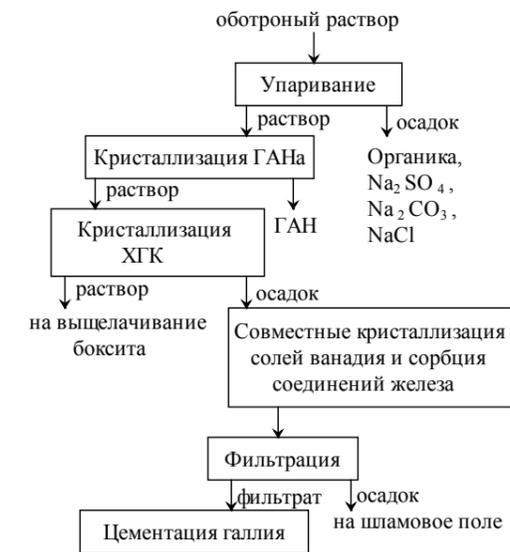
Рисунок 1 – Существующая технологическая схема производства черного галлия
