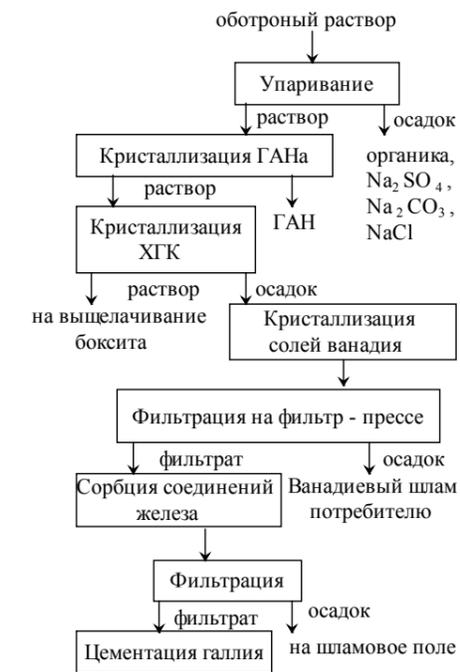
Рисунок 2 – Технологическая схема производства черного галлия с модернизированным узлом кристаллизации солей ванадия
