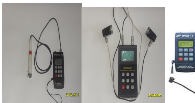
а – «ОНИКС 2.5»; б – «ПУЛЬСАР 1.0»; в – «ИЧСК 1» Рисунок 1 – Приборы неразрушающего контроля
