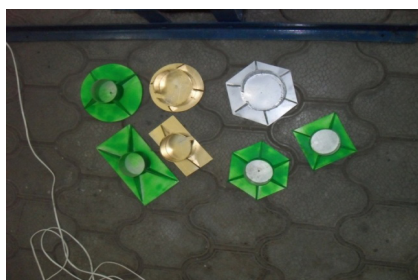
Рисунок 2 – Формы рабочих насадок
