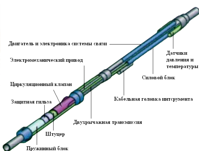
Рисунок 1- Клапан регулирования притока, спускаемый и управляемый с помощью кабеля или ГНКТ.
