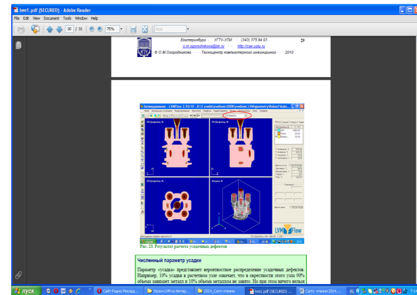
Рисунок 3 – Результат расчета усадочных дефектов
