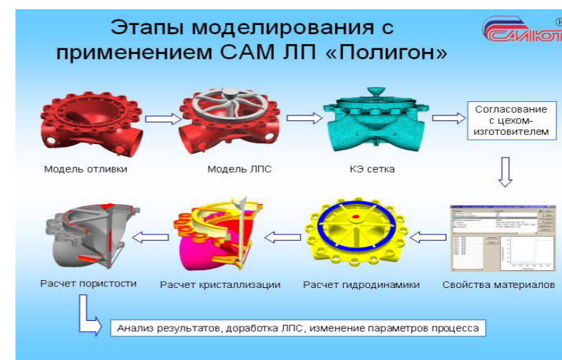
Рисунок 1 – Этапы проектирования изготовления литых деталей с применением компьютерных систем моделирования литейных процессов
