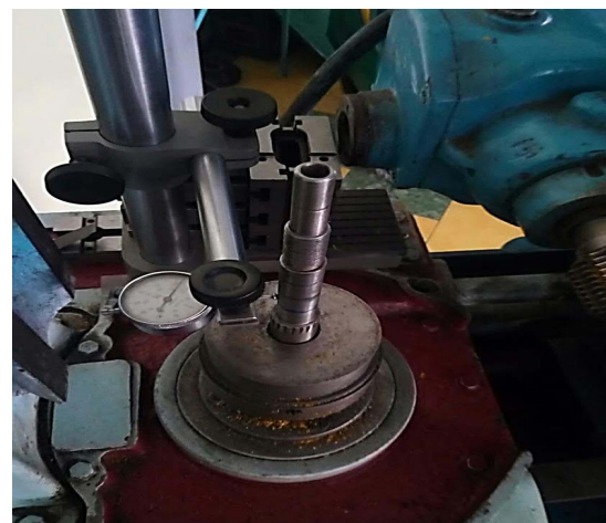
Рисунок 3 – Измерение радиального биения оправки зубофрезерного станка модели 5310
