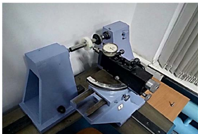
Рисунок 4 – Измерение радиального биения зубчатого венца с помощью биенимера Б-10м
