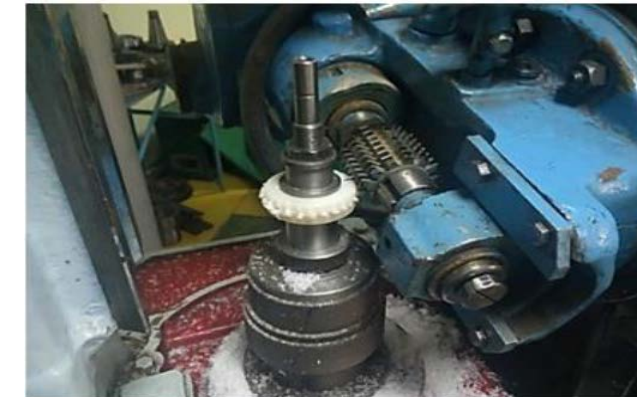
Рисунок 2 – Обработка зубчатого колеса с учетом схемы установки заготовки
