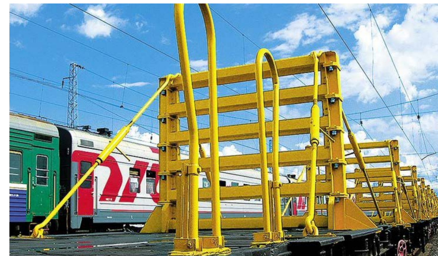
Рисунок 5 – Съемное оборудование для перевозки рельсов
