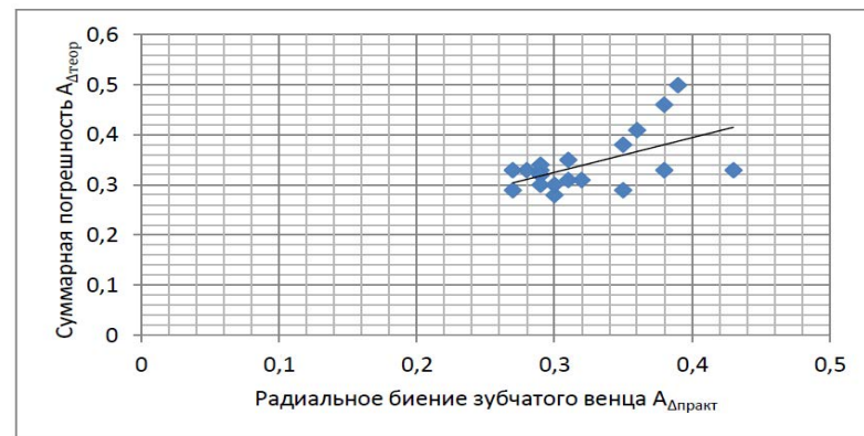
Рисунок 5 – График зависимости радиального биения ( A_{Дпpакт} ) относительно суммарной погрешности ( A_{Дтеор} )
