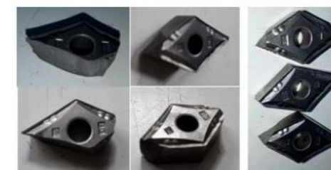
Рисунок 2 – Износ режущих пластин производство SANDVIK Coromant при обработке заготовки из стали 110Г13Л
