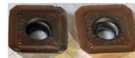
Рисунок 3 – Износ режущих пластин производство компании Korloy (Южная Корея) при обработке заготовки из стали 110Г13Л
