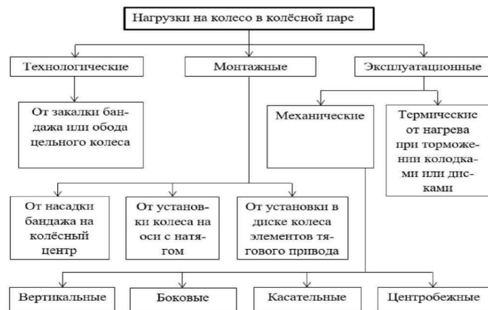
Рисунок 1 – Нагрузки, действующие на железнодорожное колесо
