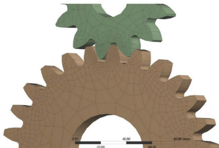
Рисунок 2 - Модель сетки конечных элементов зубчатой пары
