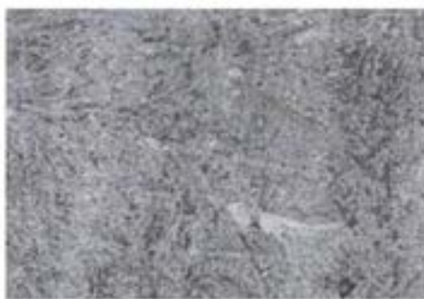
Рисунок 2 – Микроструктура на глубине 1/2 стального шара, \times 1000
