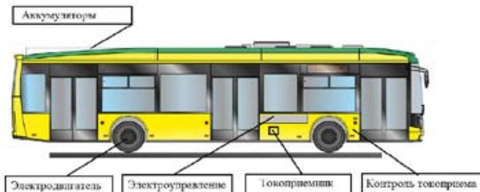
Рисунок 8 – Расположение оборудования
