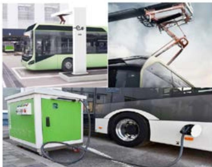
Рисунок 5 – Проводные зарядные станции для электробусов
