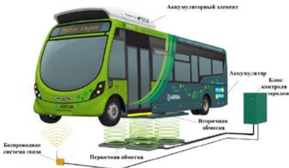
Рисунок 9 – Схема беспроводной зарядки электрических автобусов, эксплуатирующихся в Милтоне, Великобритания
