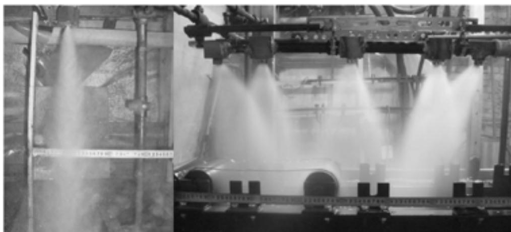
Рисунок 1 – Проливка форсунок
