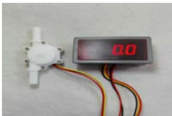
Рисунок 6 – Электронный датчик для измерения малых расходов топлива
