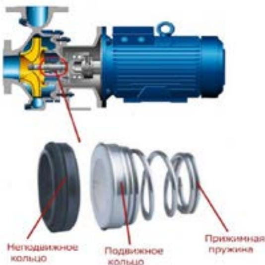
Рисунок 1 – Схема торцевого уплотнения
