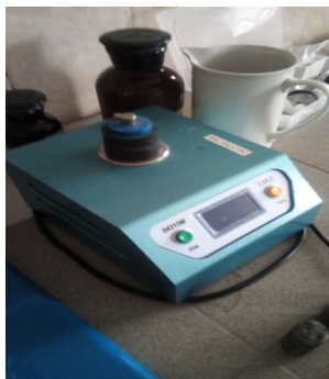
7-сурет – 04315M маркасының газ өткізгіштігін анықтауға арналған аспап Біріктіруді Nobertherm пешінде жүргізді (10-сурет).
