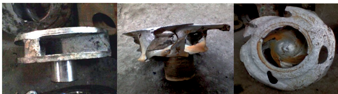
Сурет 1-Топырақ сорғысының жұмыс дөңгелегі 8Гр-8 а – жаңа жұмыс дөңгелегі; б, в-тозған жұмыс дөңгелегі
