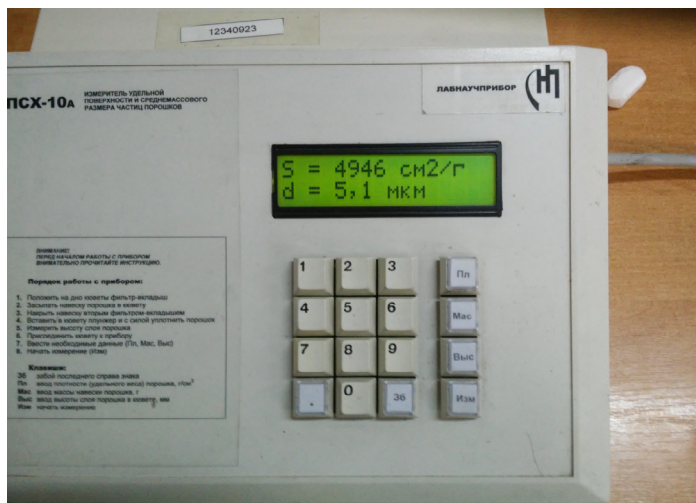
Рисунок 8 – Измерение удельной поверхности с помощью прибора ПСХ-10
