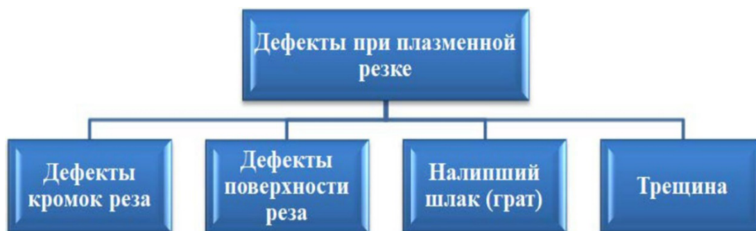
Рисунок 1 – Виды дефектов при плазменной резке
