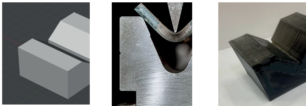
Рисунок 4 – Матрица с V-образным углублением для гибки: а) 3D модель, созданная в программе КОМПАС; б) образец матрицы из стали; в) образец матрицы, напечатанный на 3D принтере из композиционного материала TOTAL GF 10%.
