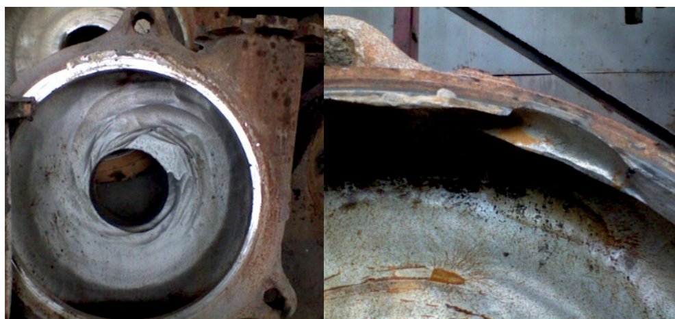
Сурет 3 – 8ГР-8 топырақ сорғысының корпусының тозуы
