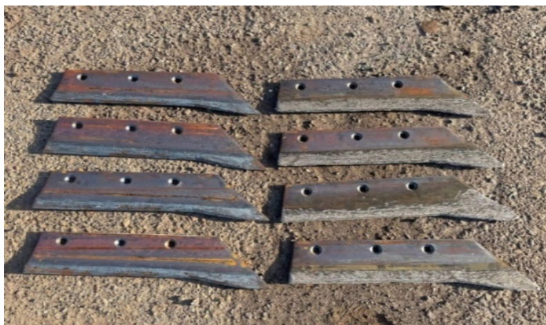
Рисунок 4 - Вид лемехов до и после ЭФУ (слева лемеха с наплавкой сормайта, справа лемеха с комбинированный обработкой ЭФУ поверх наплавки из сормайта).
