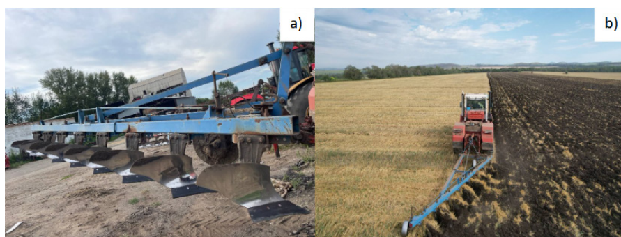
Рисунок 2 – (а) установка лемехов на подвесные плуги (б) процесс высокоскоростной вспашки поля
