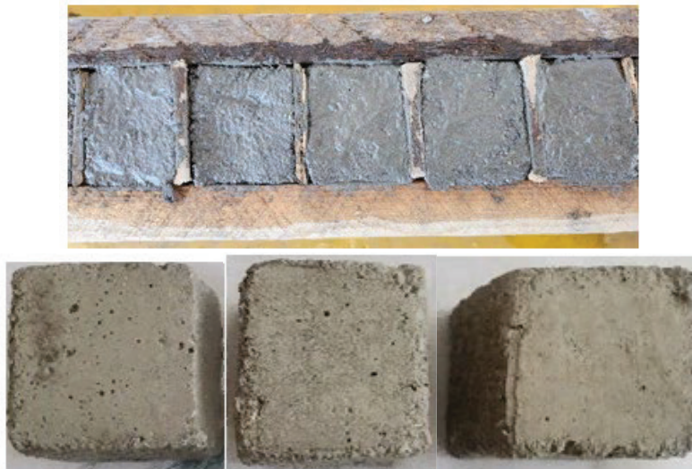
Рисунок 2 – Процесс изготовления бетонных образцов и их внешний вид
