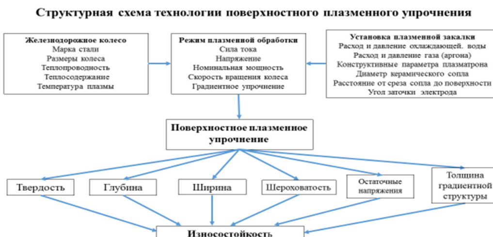
Рисунок 1 – Структурная схема технологии плазменного поверхностного упрочнения железнодорожных колес
