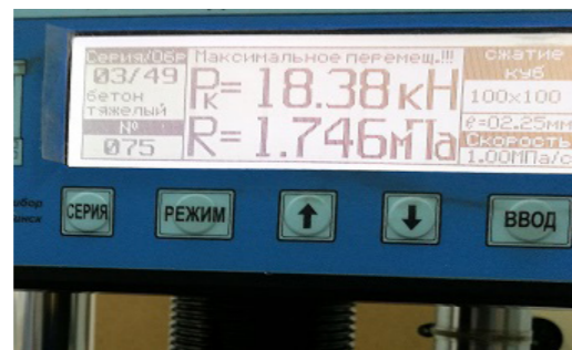
Рисунок 14 – Результат испытания на сжатие камня пустотелого стенового (размер зерен металлургического шлака составляет 2,5 мм)
