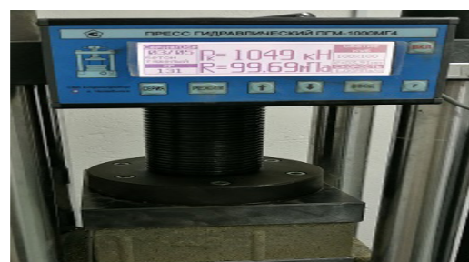
Рисунок 15 – Результат испытания на сжатие плитки тротуарной (размер зерен металлургического шлака составляет 0,5 мм)
