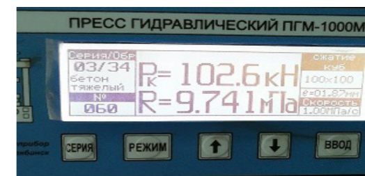
Рисунок 17 – Результат испытания на сжатие плитки тротуарной (размер зерен металлургического шлака составляет 4,0 мм)
