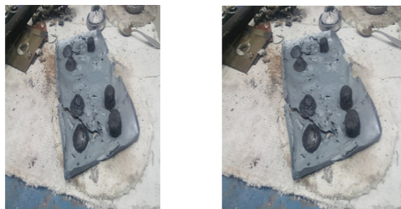
а) – брикеты восстановленные при температуре 1200 °С; б) – брикеты восстановленные при температуре 1300 °С;
