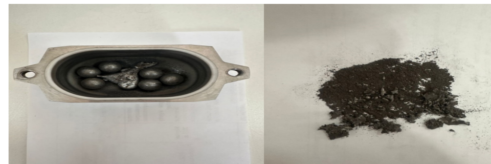
а б Сурет 1 – ЕМах диірменінде скрап (а) және феррокорытпаларды (б) ұнтақтау
