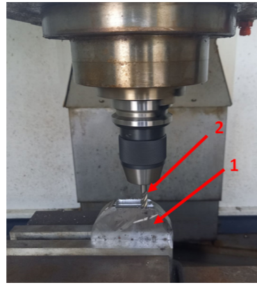
а – ысқылап қалыптастыру процесі; 1 – дайындама; 2 – саусақты фреза Сурет 2 – Саусақты фрезаларды ысқылап қалыптастыру процесі
