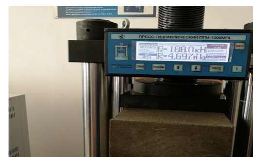
Рисунок 13 – Результат испытания на сжатие камня пустотелого стенового (размер зерен металлургического шлака составляет 2 мм)
