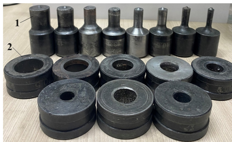
1 – шина пробивные инструменты различных диаметров; 2 – пуансоны
