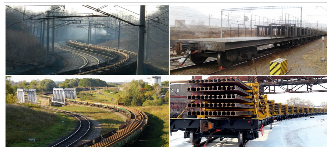
Рисунок 1 – Перевозка длинномерных рельсовых плетей рельсовозами по железным дорогам России
