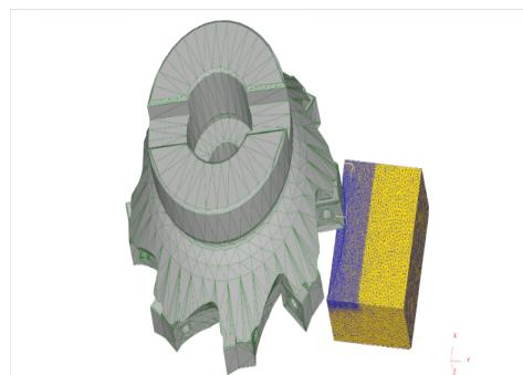
Рисунок 1 – Фреза и заготовка, смоделированные с помощью DEFORM-3D
