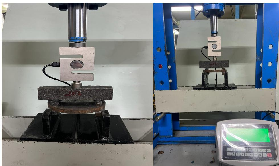
Сурет 2 – Механикалық сынақтар жүргізілген гидравликалық пресс және электронды динамометр
