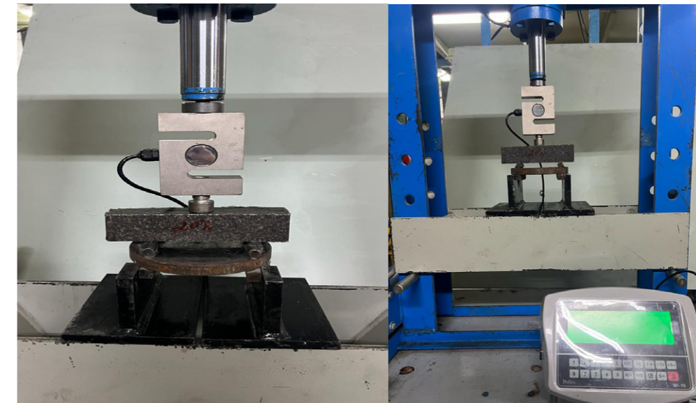
Сурет 2 – Механикалық сынақтар жүргізілген гидравликалық пресс және электронды динамометр
