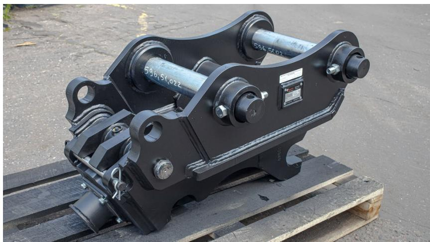
Рисунок 1 – Быстроъемный соединитель
