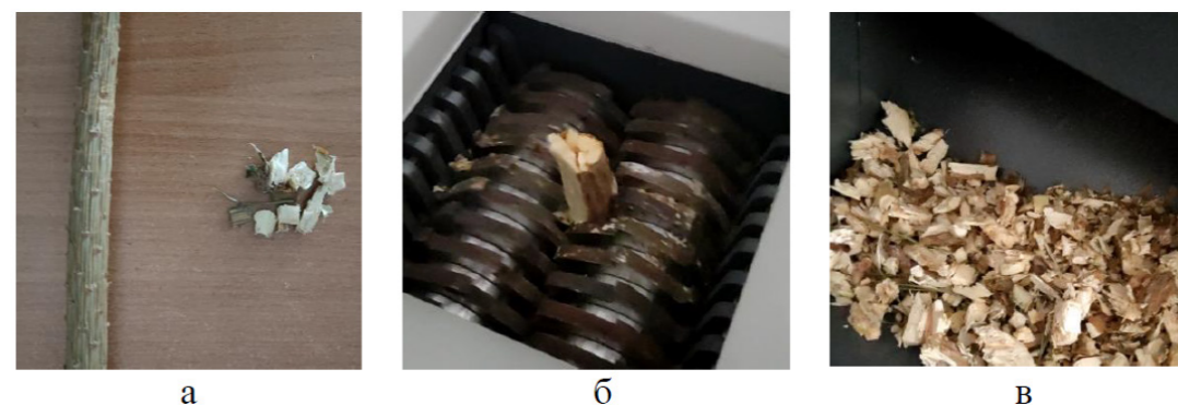
Рисунок 7 – Фрагменты разрушения древесного отхода (елочной ветки) в шредере EB180
