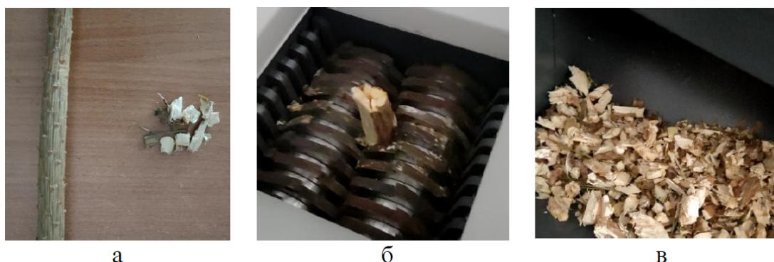
Рисунок 7 – Фрагменты разрушения древесного отхода (елочной ветки) в шредере EB180
