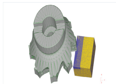
Рисунок 1 – Фреза и заготовка, смоделированные с помощью DEFORM-3D
