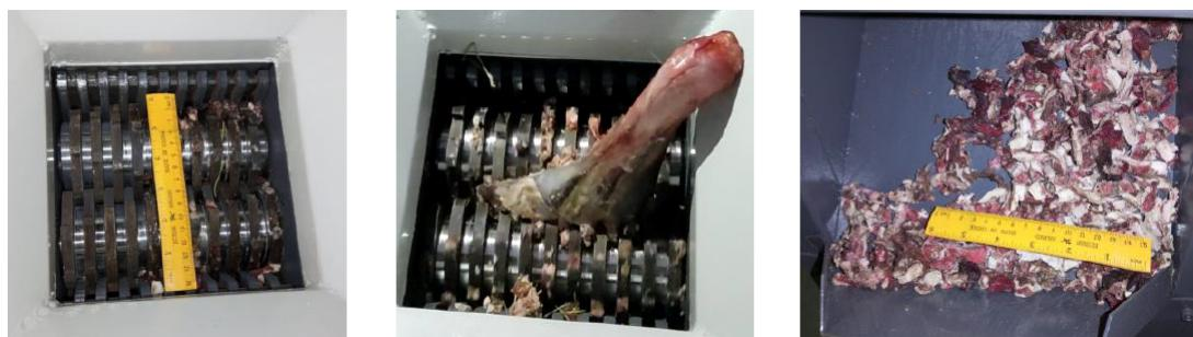
Рисунок 6 – Фрагменты разрушения мясокостного конфиската в шредере EB180
