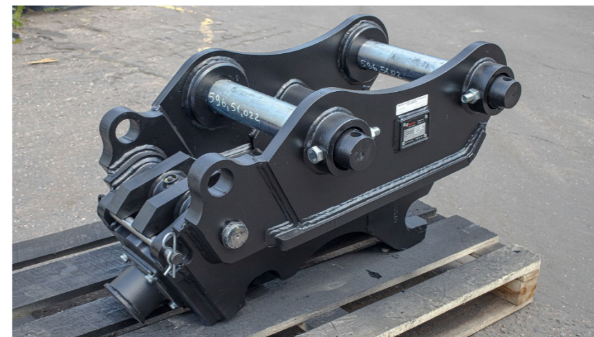
Рисунок 1 – Быстроразъемный соединитель механический с винтовым принципом
