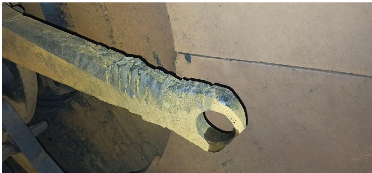
Рисунок 4 – Износ крайних билодержателей после отработки 1800 часов.
