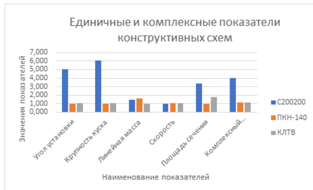
Рисунок 3 – Единичные и комплексные показатели конструктивных схем конвейеров
