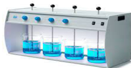
Рисунок 1 – Лабораторная установка «JLT4 Leaching test/ Jar test» фирмы «VELP Scientifica»
