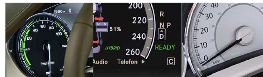
Рисунок 4 – Индикатор состояния готовности на: Audi A8 hybrid, Mercedes S400, Chrysler Aspen Hybrid
