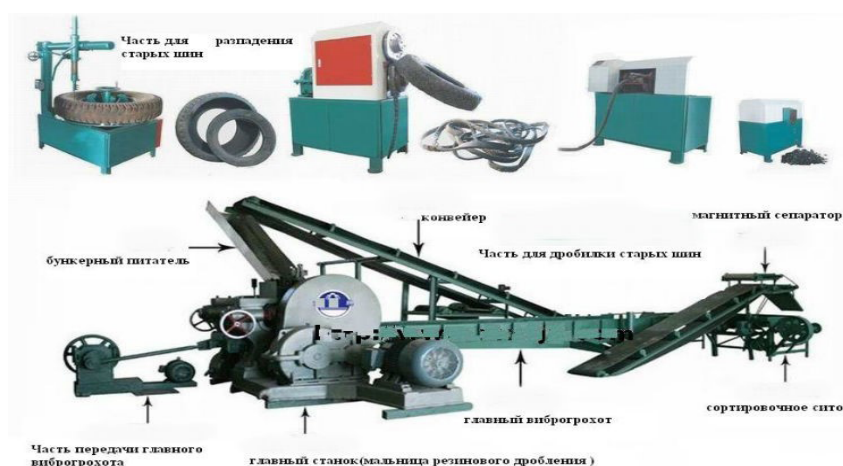
Рисунок 1 – Производственный процесс для обработки покрышек и измельчения шин до резиновой крошки
