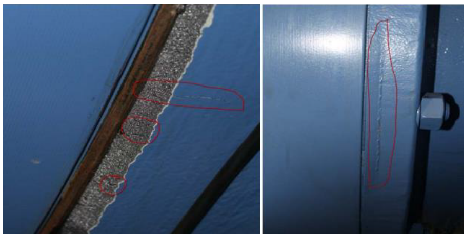
Сурет 2 – Редуктордың цилиндрлік сатысының корпусының жарылуы
