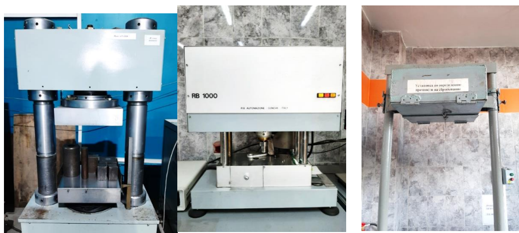
Рисунок 3 – Гидравлический пресс: а – ИП-1000, б – RB-1000, в – установка по определению прочности на сбрасывание
