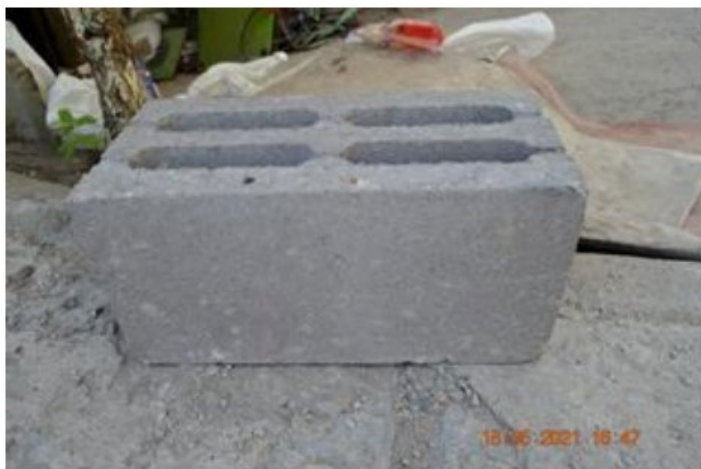
Рисунок 2 – Образец «Камня стенового пустотелого» для испытаний
