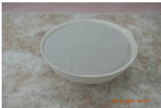
Рисунок 1 – Микросфера ТОО «KazCenosphere's» (РК, Павлодарская область, ГРЭС-2)
