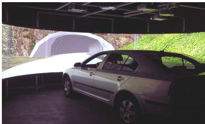
Рисунок 8 – Симулятор вождения Octavia II, разработанный FD CTU в Праге [12]
