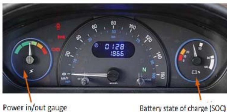
Рисунок 1 – Пример панели аналоговых датчиков с индикатором заряда и входа / питания
