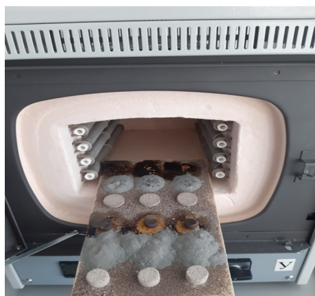
Рисунок 7 – Процесс обжига сырьевых материалов
