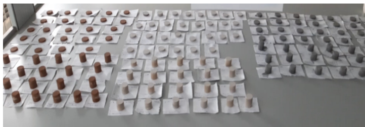
Рисунок 4 – Образцы таблеток и цилиндров со шлаком, золой-уноса и КШ
