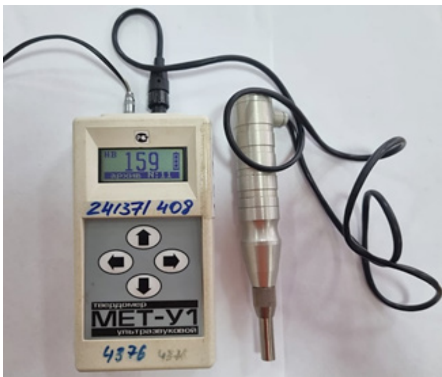
Рисунок 4 – Твердомер портативный ультразвуковой MET-U1
