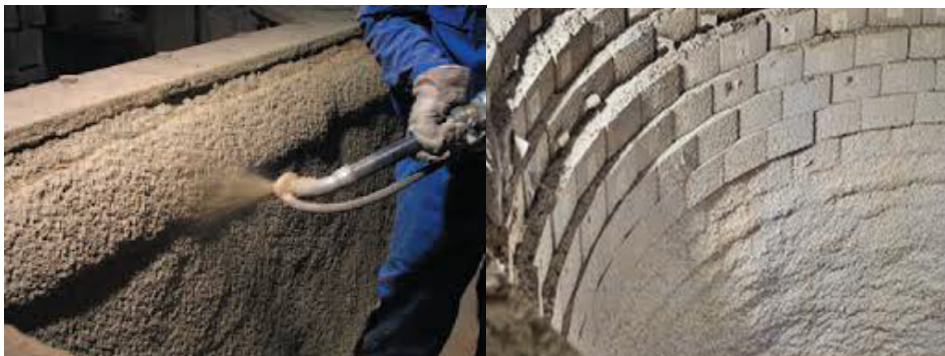
Рисунок 3 – Торкретирование разливочных ковшей
