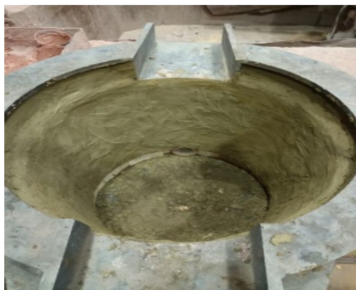
Рисунок 4 – Нанесенная защитная обмазки на основе молотого боя шамота
