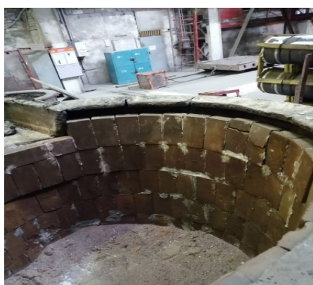
Рисунок 2 – Футеровка ковша для разлива феррохрома марок ФХ600-650
