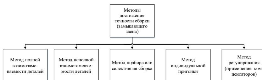
Рисунок 1 – Методы достижения точности сборки (точности замыкающего звена)
