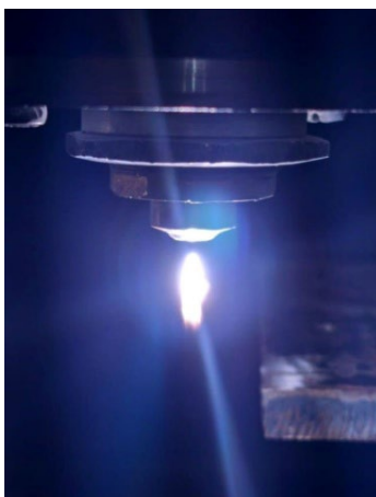
Рисунок 8 – Оптический пульсирующий разряд в струе аргона, P = 0,05 \text{ МПа} , W = 1,5 \text{ кВт} , f = 40 \text{ кГц} , F = 63,5 \text{ мм} .
