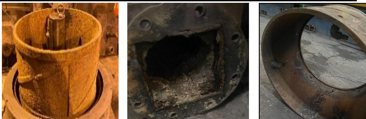
Сурет 7 – Барабанның қабырғасындағы қақтар
