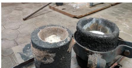
Рисунок 2 – Образцы профильтрованного алюминия-сырца
