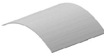
Рисунок 5 – Модель профиля упругого раздвижного элемента разработанная в программе «ПС ЛИРА»
