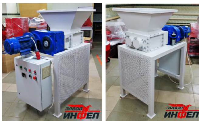
Рисунок 1 – Двухвальный шредер DB-5: а – вид спереди; б – вид сзади
