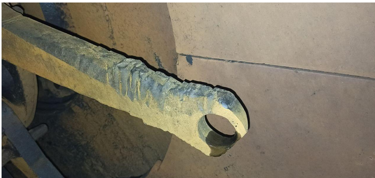
Рисунок 4 – Износ крайних билодержателей после отработки 1800 часов
