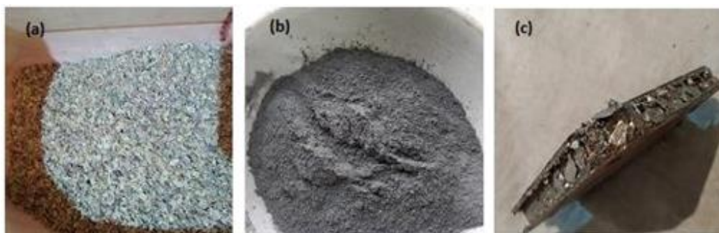
Рисунок 1 – Платы после: (а) барабанной дробилки QL-300; (б) мельницы; (с) магнитной сепарации
