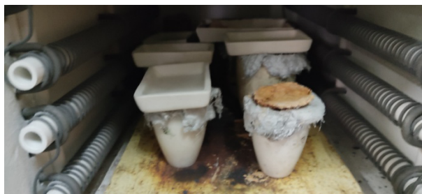
Рисунок 2 – Нагрев образцов до температуры 1200 °С
