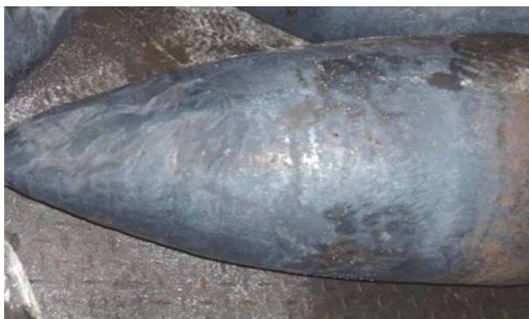
Сурет 1 – «Бүрме» жұмыс бөлігінің тозуға ұшыраған тескіш құралбіліктің сыртқы көрінісі
